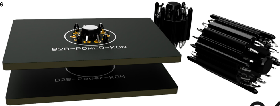
Abb. 1: Direktsteck- Technologie (Gegenstecker entfällt)
